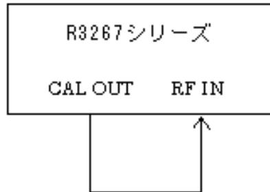
図 6-6 周波数偏移測定接続図 (DECT)
