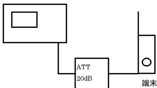
図 2-1 GSM 測定の接続
