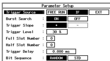
図 3-30 Parameter Setup ダイアログ・ボックス
