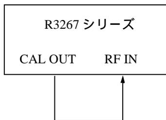
図 6-3 変調精度測定接続図 (EDGE)
