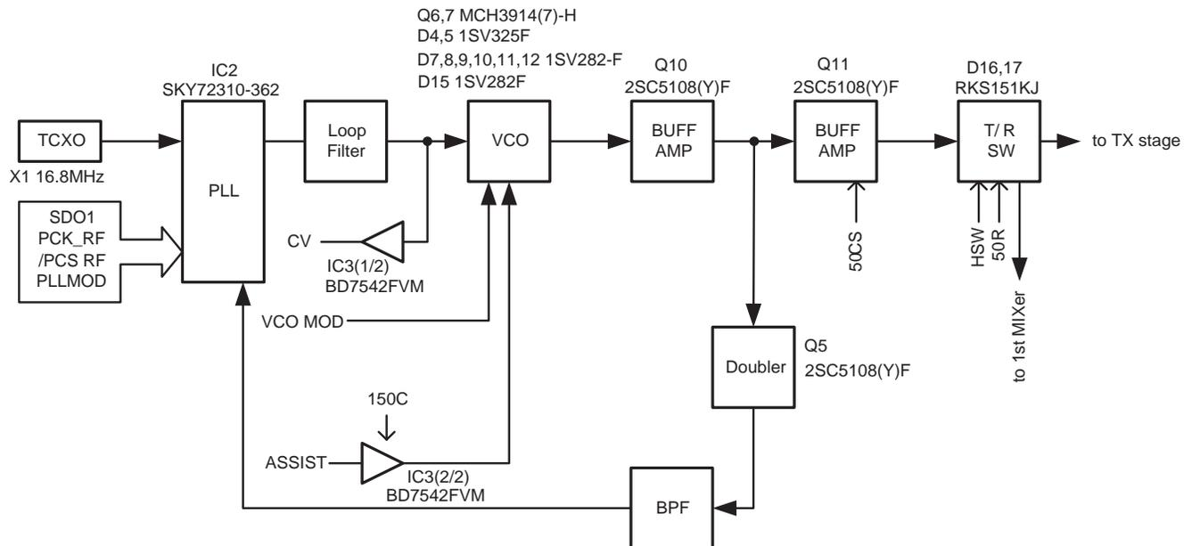
Fig. 6 PLL circuit
